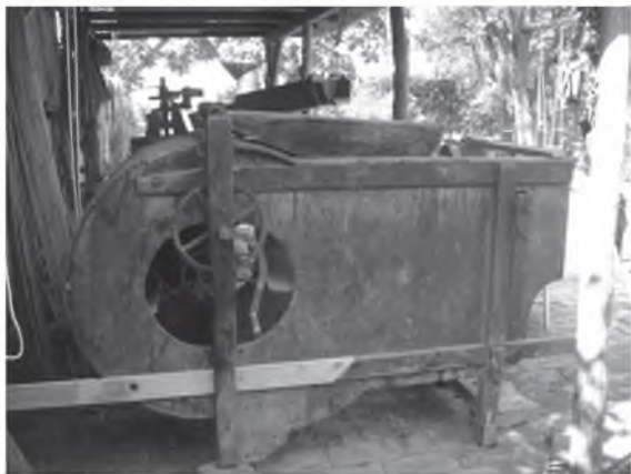
“Dreš” - separator za odstranjivanje lakih primesa iz žitarica i zrnastih plodova
