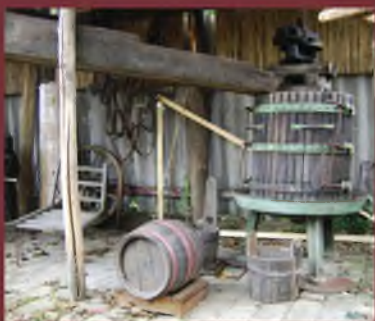
Pres za ceđenje grožđa sa levkom za punjenje sa kola.
